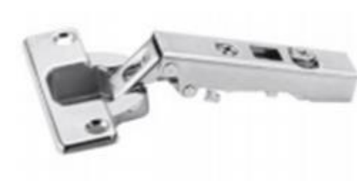
Modèle 9943 Epaisseur de porte supérieure à 15 mm Diamètre de boîtier 35 mm Réglage de recouvrement intégré Réglage en profondeur à excentrique intégré Réglage en hauteur par embase
