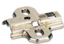
Type 9000 Plaque de montage à visser Trous oblongs pour réglage de hauteur Entraxe 32mm, fixation à 37 mm du bord Acier nickelé
